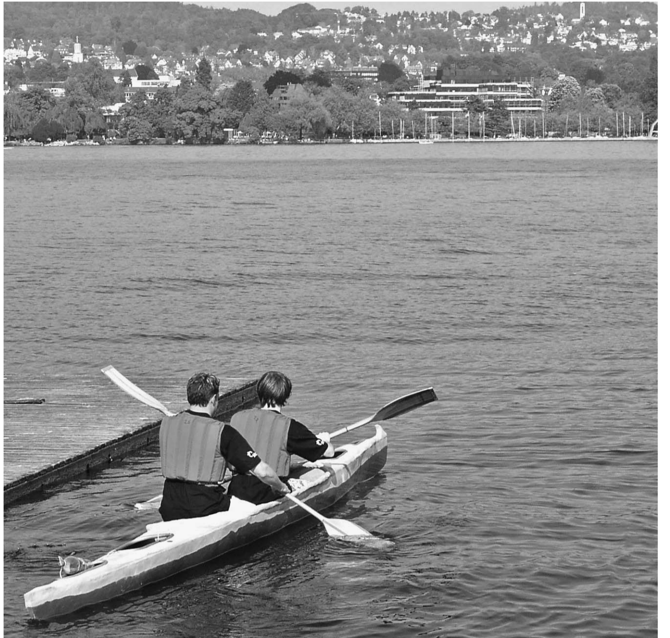
Gestern Donnerstag testete die ETH Zürich auf dem Zürichsee ihr eben auf den Namen «Welcome Tomorrow» getauftes nur 47 Kilogramm schweres Betonkanu. Das 6 Meter lange Boot war von Bauingenieur-Studenten der ETH entworfen und gebaut worden. Die Jungfernfahrt endete zwar mit dem Kentern des Bootes, doch war das auf die noch unzureichenden Fähigkeiten der Paddler, das Gleichgewicht zu halten und nicht auf die Qualitäten des aus ungewohntem Material hergestellten Kanus zurückzuführen. Unter dem Slogan des 150-Jahre-Jubiläums der Hochschule wird es die Schweiz an der Deutschen Betonkanu-Regatta vom 17. und 18. Juni in Heidelberg vertreten. (Bild: zvg)
